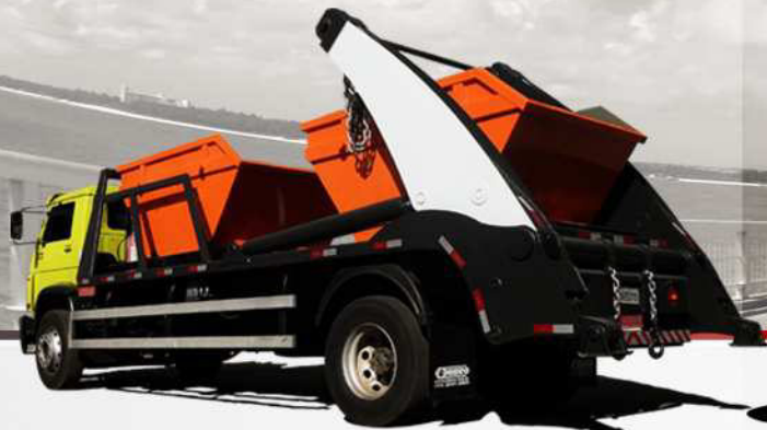
Poliguindaste Telescópico/Articulável de 8t à 12t
